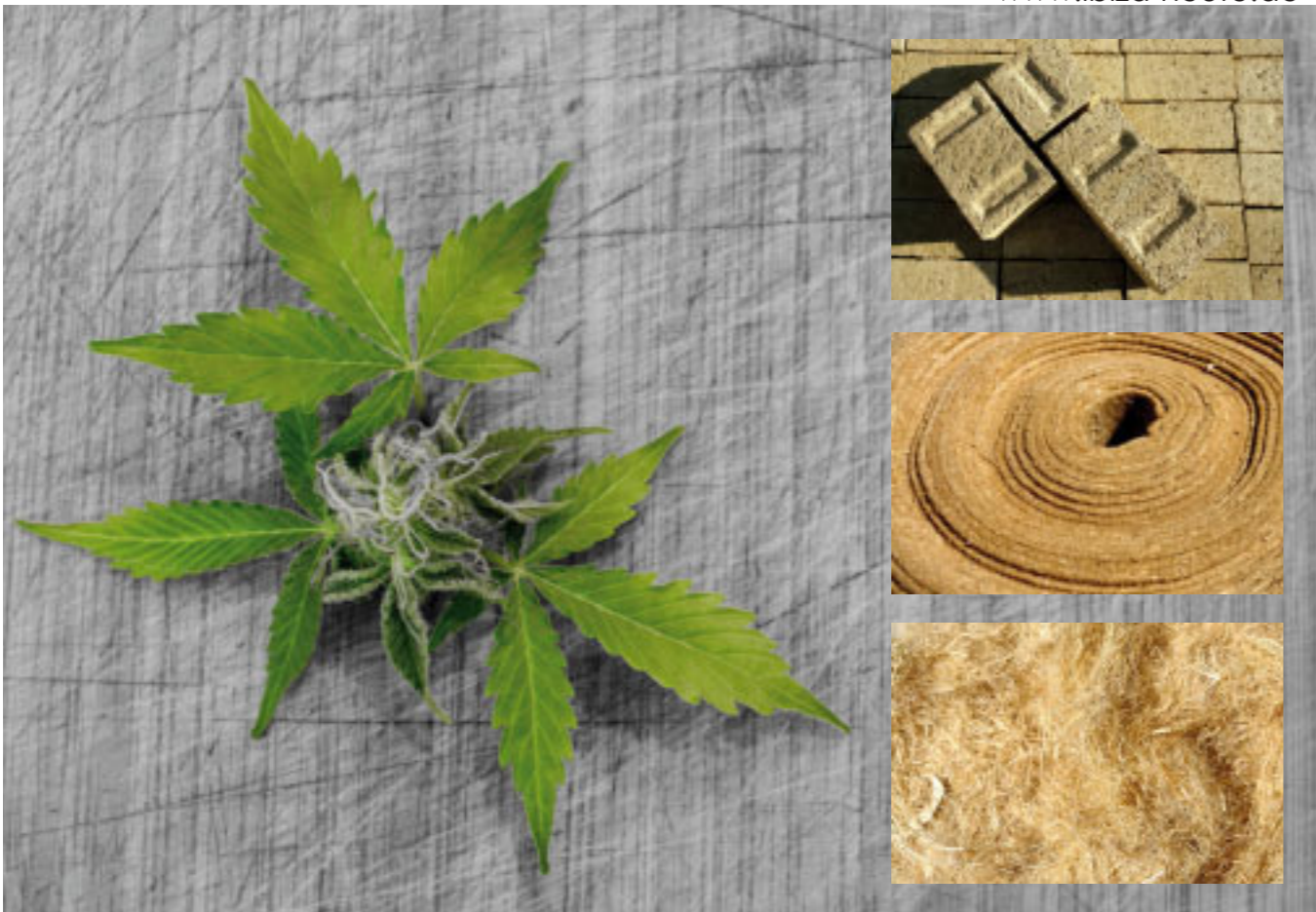
Wiederentdeckt: Hanf – ein natürlicher Baustoff mit idealen bauphysikalischen Eigenschaften und hohen Dämmwerten. Natürlich gänzlich frei von halluzinogenen Substanzen. „Cannabric“ (kl. Fotos) soll sogar Niedrigenergie-Häuser ermöglichen
