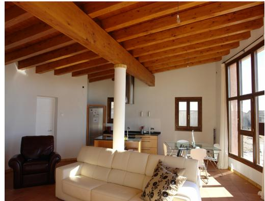
Imagen 4. Interior de una vivienda unifamiliar aislada con muros de carga monocapa de Cannabric, con revestimientos de yeso, Arquitecta Petra Jebens-Zirkel, Aragón.
